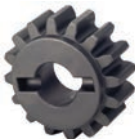
Pignone Z16 modulo 6 con protezione per cremagliera 719169
