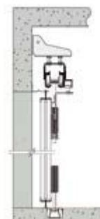
Posa oltre luce Installation to the wall Einbau auf der Wand
