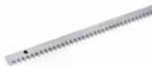
Cremagliera zincata 30x12 mod. 4 con attacchi a saldare inclusi (confez. da 4 m)
