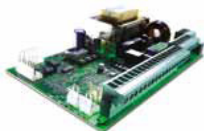
Scheda elettronica dissuasore JE275 gestione fino a max 4 dissuasori J200 HA
